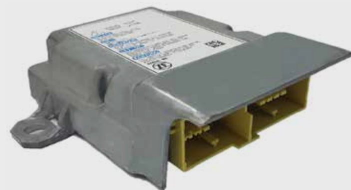
Atuando como o cérebro do airbag, além de acioná-los e detectar acidentes, ACU funciona como "caixa-preta" para o veículo
