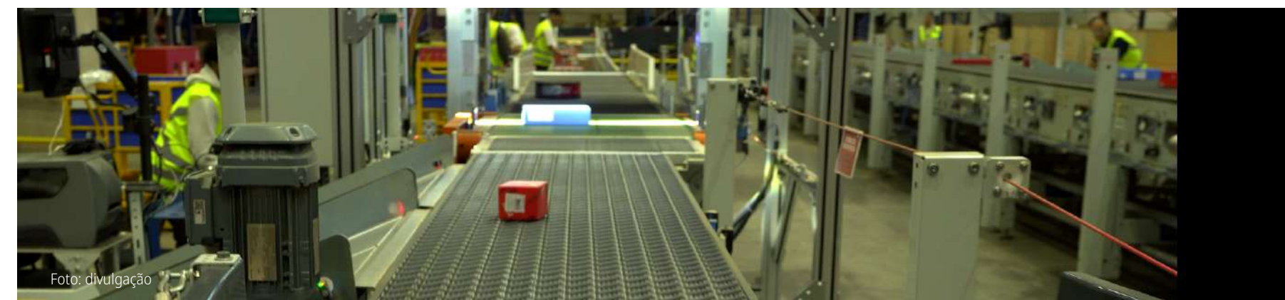
Nova esteira seletora tem capacidade para classificar três mil volumes por hora
