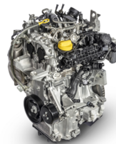
Desempenho é alcançado por meio de injeção direta turbo controlada eletronicamente
