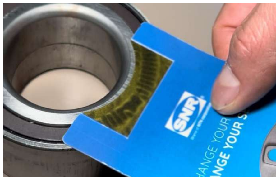
Cartão ASB ajuda a verificar as condições do encoder do rolamento e se está enviando informações
